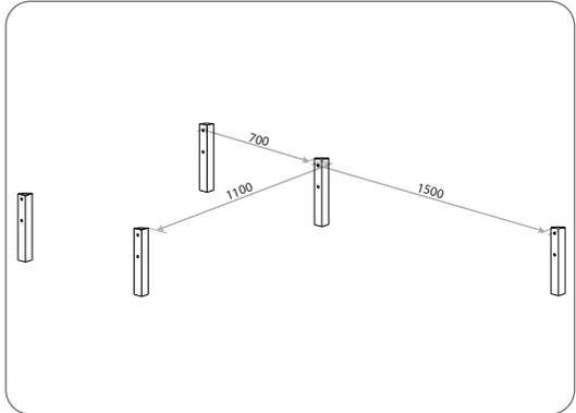
Dopo aver montato la parte in superficie dell'attrezzo, misura la distanza tra i profili verticali, o appoggia il telaio a terra e fai delle buche profonde almeno 60 cm.
