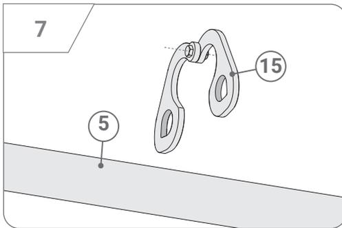
Placer un morceau de caoutchouc entre la pince et le tube de la barre pour éviter que la pince ne glisse sur la barre.
